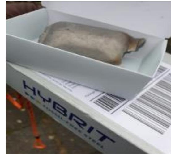
Горячебрикетированное железо, полученное на пилотной установке в рамках проекта HYBRIT.
