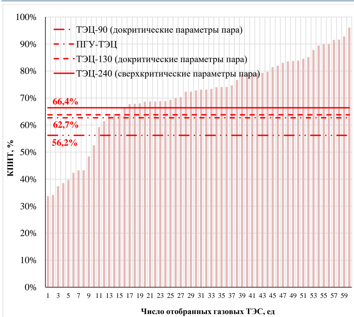
Рисунок 9.2 Бенчмаркинг газовых ТЭС по КПИТ: (а) по числу электростанций и (б) по объемам производства электрической и тепловой энергии
